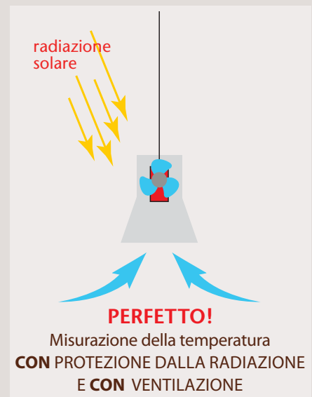
Figura 1.7 - Esempio di corretto posizionamento della strumentazione
