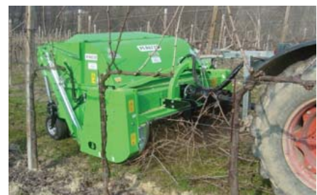
Figura 2.4 - Trincia raccoglitrice per la raccolta di potature di vite (sinistra) e di nocciolo.
