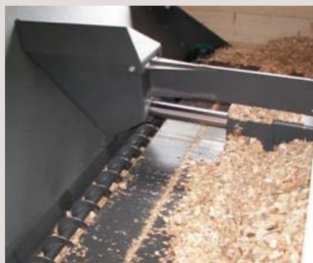
Figura 3.4– Particolare di un sistema a rastrelli.
